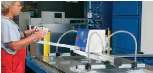
VacuMaster Comfort, maximum load 250 kg, horizontal
